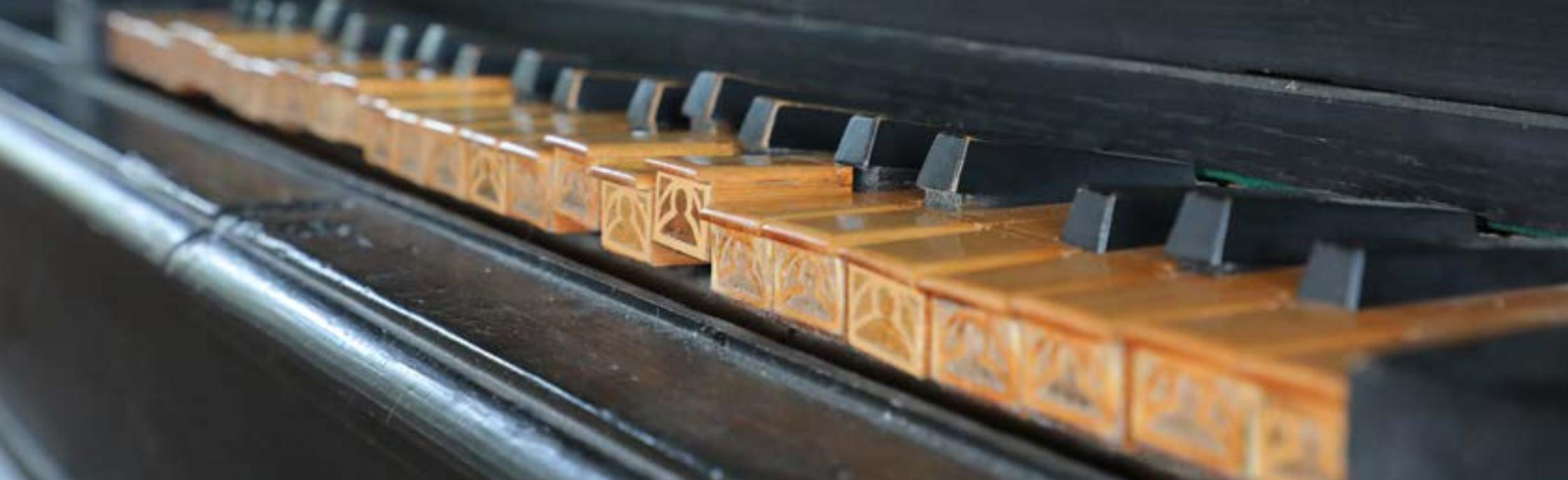
die originalen sind. Lediglich die Oberlabien - das ist die Kante einer Pfeife aus Holz, die der Tonerzeugung dient - wurden teilweise umgebaut und sollen durch massives Eichenholz ersetzt werden. Die Spunde - also die Holzzapfen der Pfeifen - werden ebenfalls repariert und neu beledert.
